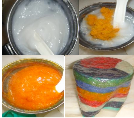
Figura 2. Proceso de elaboración de los biopolímeros de almidón de corteza de yuca y fibra natural
